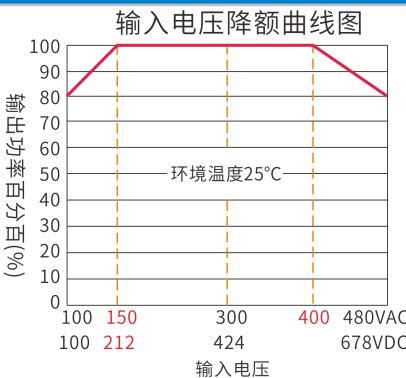
注 1：输入电压为 100~150VAC, 400~480VAC 需在输入电压降额曲线图的基础上进行电压降额使用。
