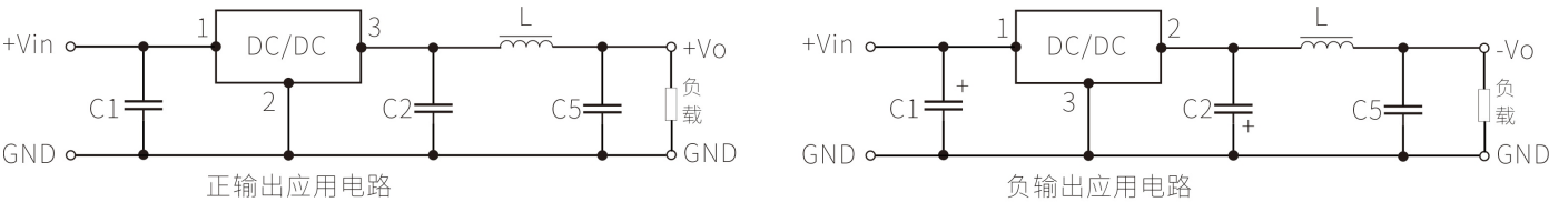
图3 ‘LC’ 滤波应用电路
