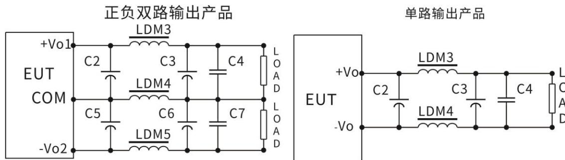
C2、C5 即可；对纹波&amp;噪声要求严格时；推荐使用上图电路。
