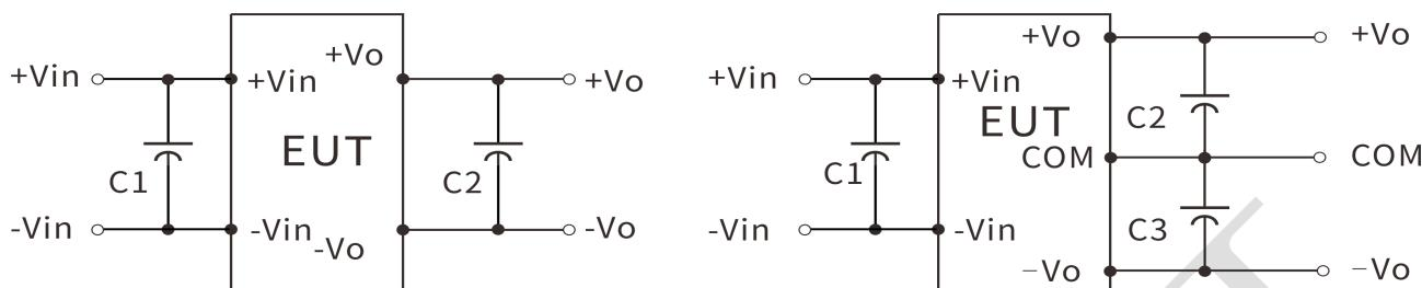
2、纹波&amp;噪声测试: (双绞线法 20MHz 带宽)
